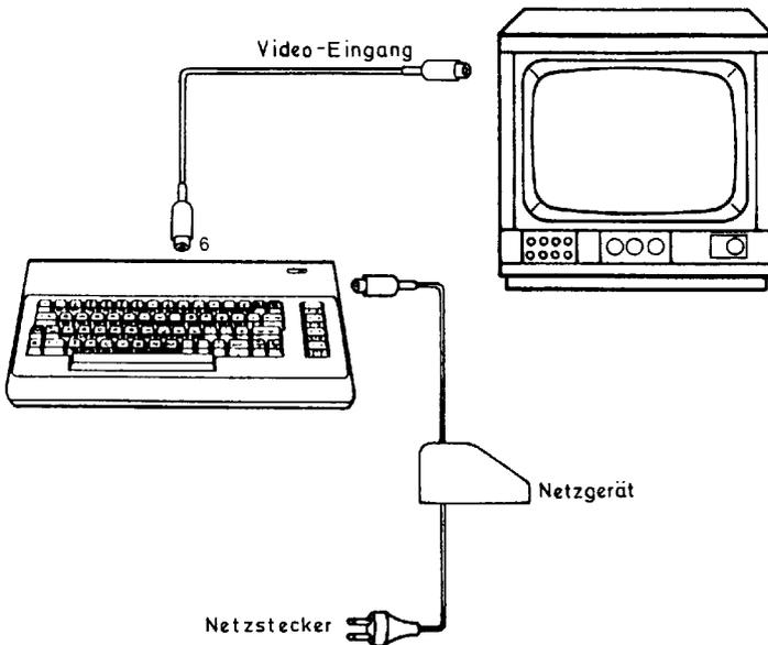
Zum Empfang normaler Fernseh-Sendungen müssen Sie das Video-Kabel in der Regel entfernen.
