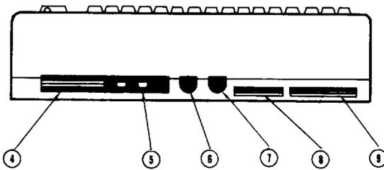
7. **Serieller Ausgang.** Zum Anschluß eines Druckers oder eines Disketten-Einzellaufwerks.
