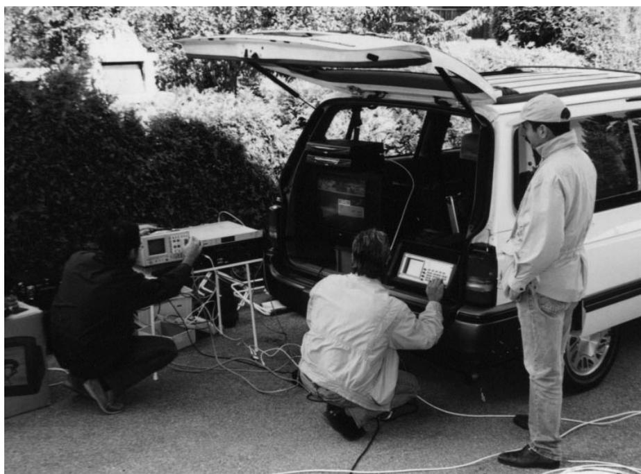
Messarbeiten im Felde zur Überprüfung der Empfangsqualität
