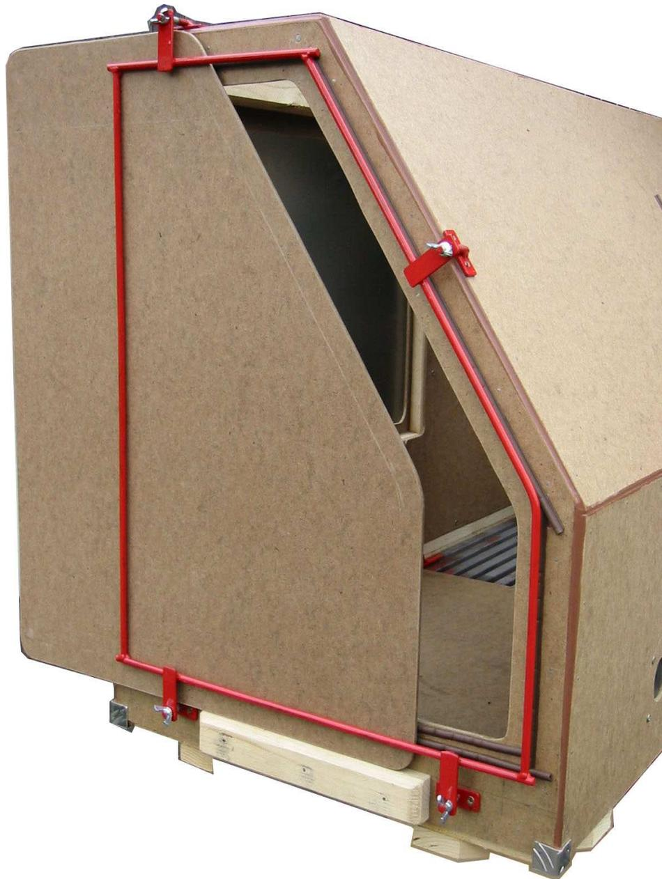
Die Seitenplatte kann von Links einfach eingeschoben werden. Der Stahlrahmen braucht dabei nur gelöst und nicht vollständig demontiert zu werden.
