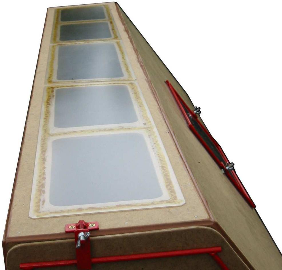
Auch auf der Oberseite befinden sich drei Plexiglasplatten. Hat man einmal zuwenig Sonnenlicht, oder arbeitet man in einem Raum, so kann problemlos eine Lampe daraufgestellt werden um genügend Licht ins Innern der Kabine zu bekommen. Diese Lösung ist problemloser als die Montage einer Lampe in der Kabine.
