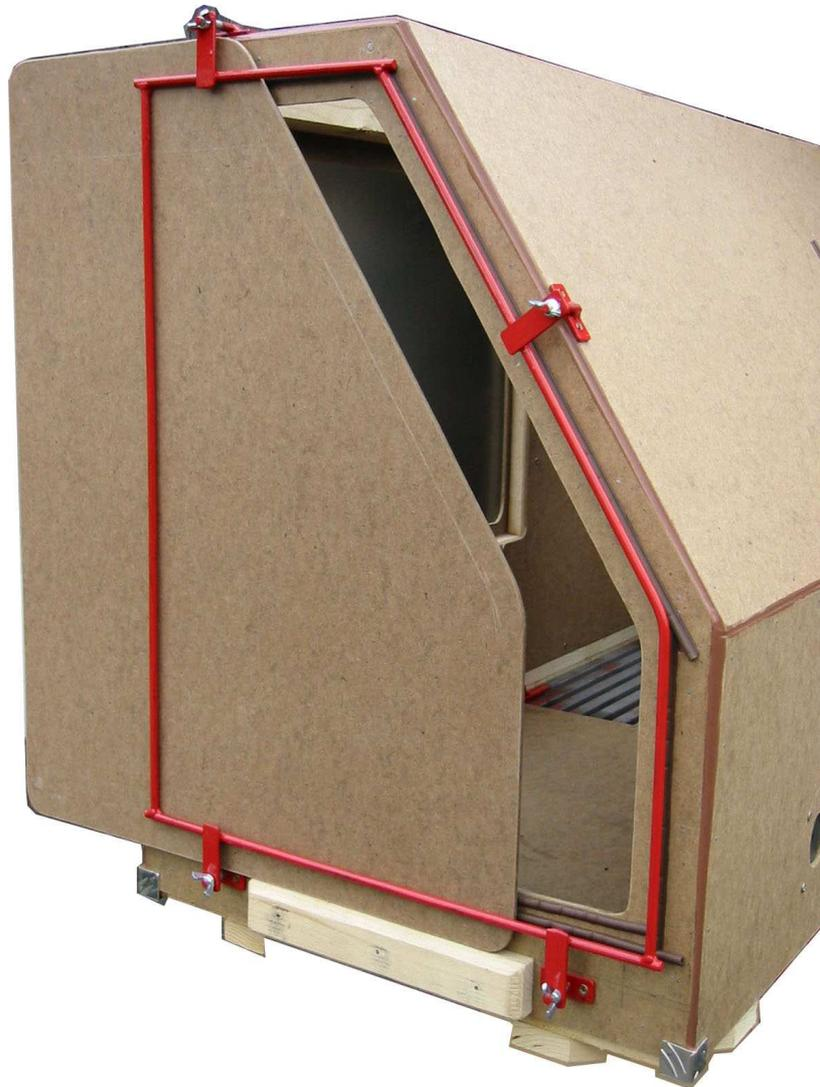
Die Seitentüre besitzt das gleiche Prinzip wie die Durchsichtöffnung. Auch hier wird die Pavatexplatte mit einem Stahlrahmen niedergespannt. Nach dem Lösen der vier Flügelmutter kann die Platte nach links weggeschoben werden. Den Stahlrahmen braucht man dabei nicht zu demontieren.
