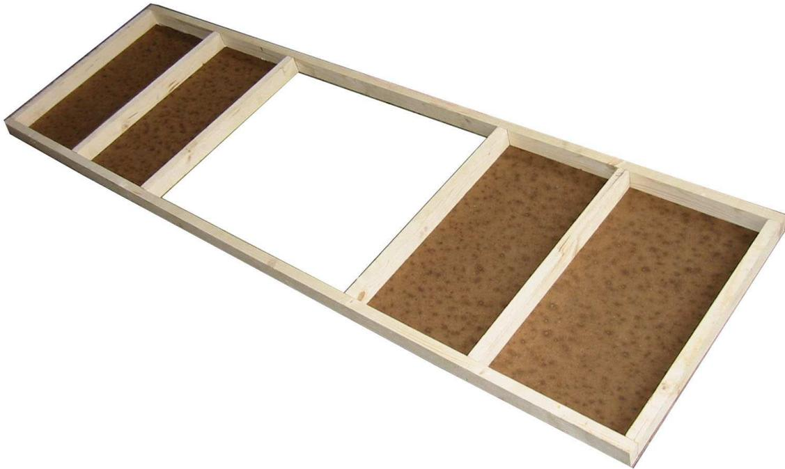
Zuerst wird der Rahmen verleimt und danach die zwei Pavatexplatten darauf befestigt (Ansicht von unten).
