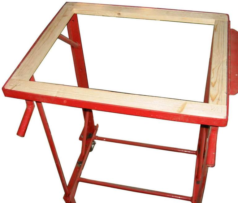
Damit später alles genau passt, habe ich zuerst den Holzrahmen dem Fahrgestell angepasst und ihn verleimt. Danach wird der Rahmen auf der Unterseite der Kabine befestigt.
