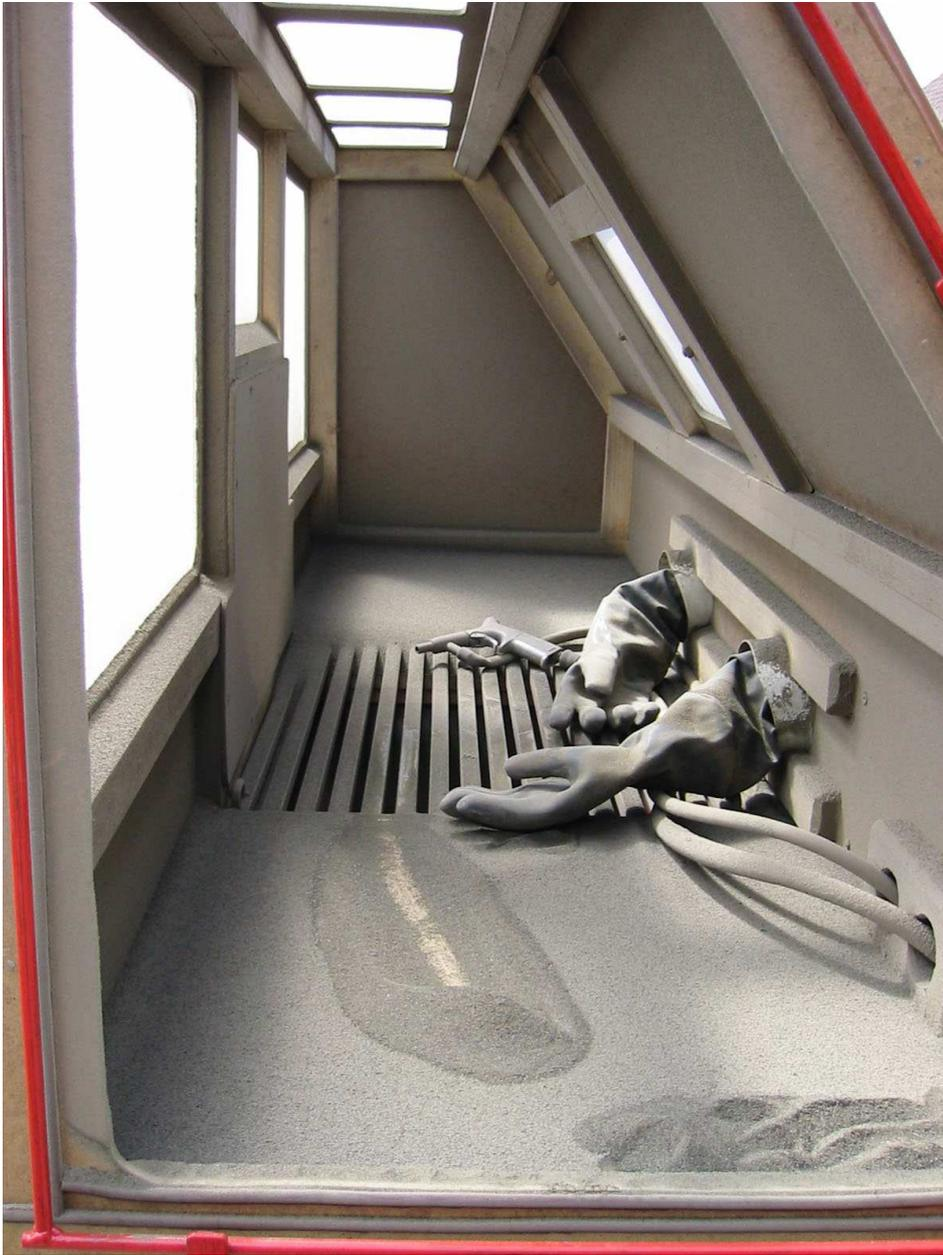
Da sich im Betrieb ziemlich viel Sand auf den Flächen links und rechts des Gitterrostes ablagert, ist ein Rechen nötig, um dieses Material in den Rost (Auffangtrichter) zu schieben. Der notwendige Rechen ist im Kapitel Zubehör beschrieben.
