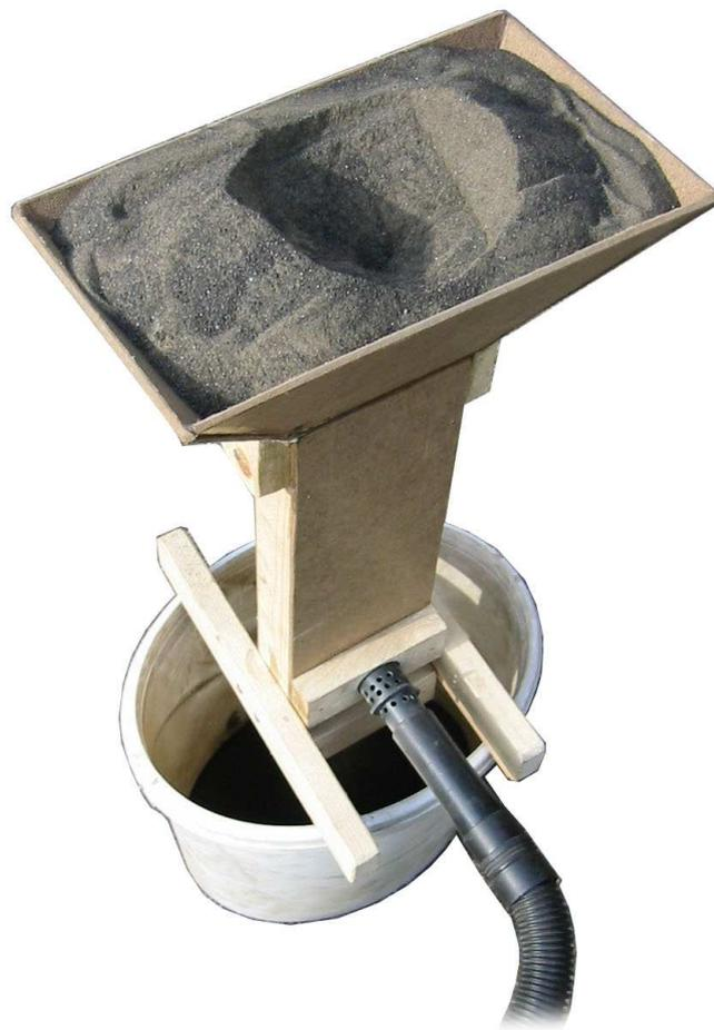
Grundprinzip: Der im oberen Trichter vorhandene Sand wird in einem Kamin (Querschnitt 48 x 80 mm) fein verteilt und zuunterst saugt ein Staubsauger die kleinen, leichten Staubteile aus der Luft und die grösseren Korundkörner fallen in den Kübel.
