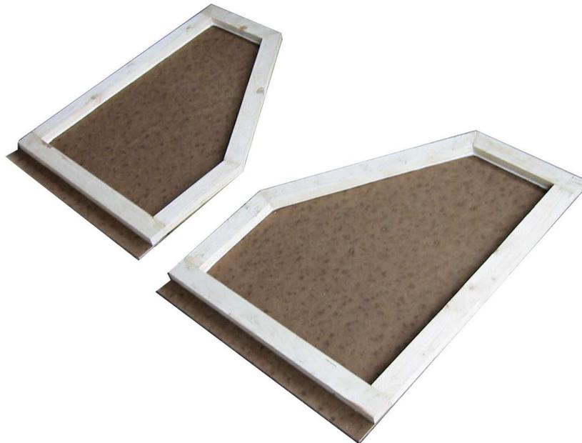
Nun werden die Seitenrahmen mit den Pavatexplatten verleimt. Achtung, diese beiden Teile müssen spiegelverkehrt erstellt werden.
