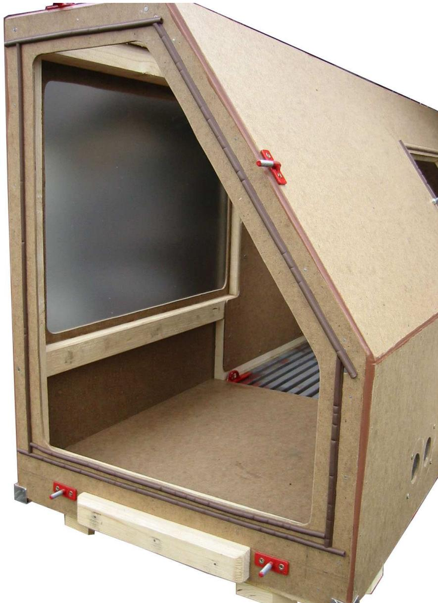
Die Seitentüre ist nach dem gleichen Prinzip aufgebaut, wie die Durchsichtöffnung. Wichtig ist auch hier, dass der Gummi unter den Stahlrahmen zu liegen kommt.
