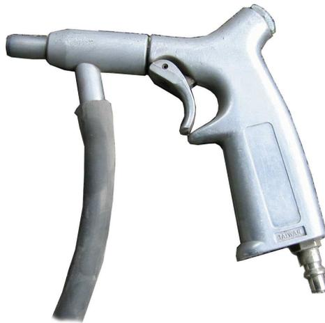
Die Pistole funktioniert folgendermassen. Der schwarze Schlauch führt das Strahlgut zur Pistole, bzw. Es wird durch das Luftvakuum angesaugt. Rechts unten am Griff befindet sich die Schnellkupplung für den Druckluftschlauch. Ich arbeite dabei mit einem Druck von ca. 6 Bar.
