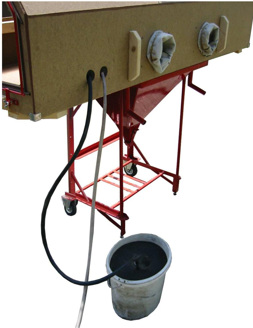
Hier sieht man den weissen Druckluftschlauch, sowie den schwarzen der das Korund vom Kübel in die Kabine führt.
