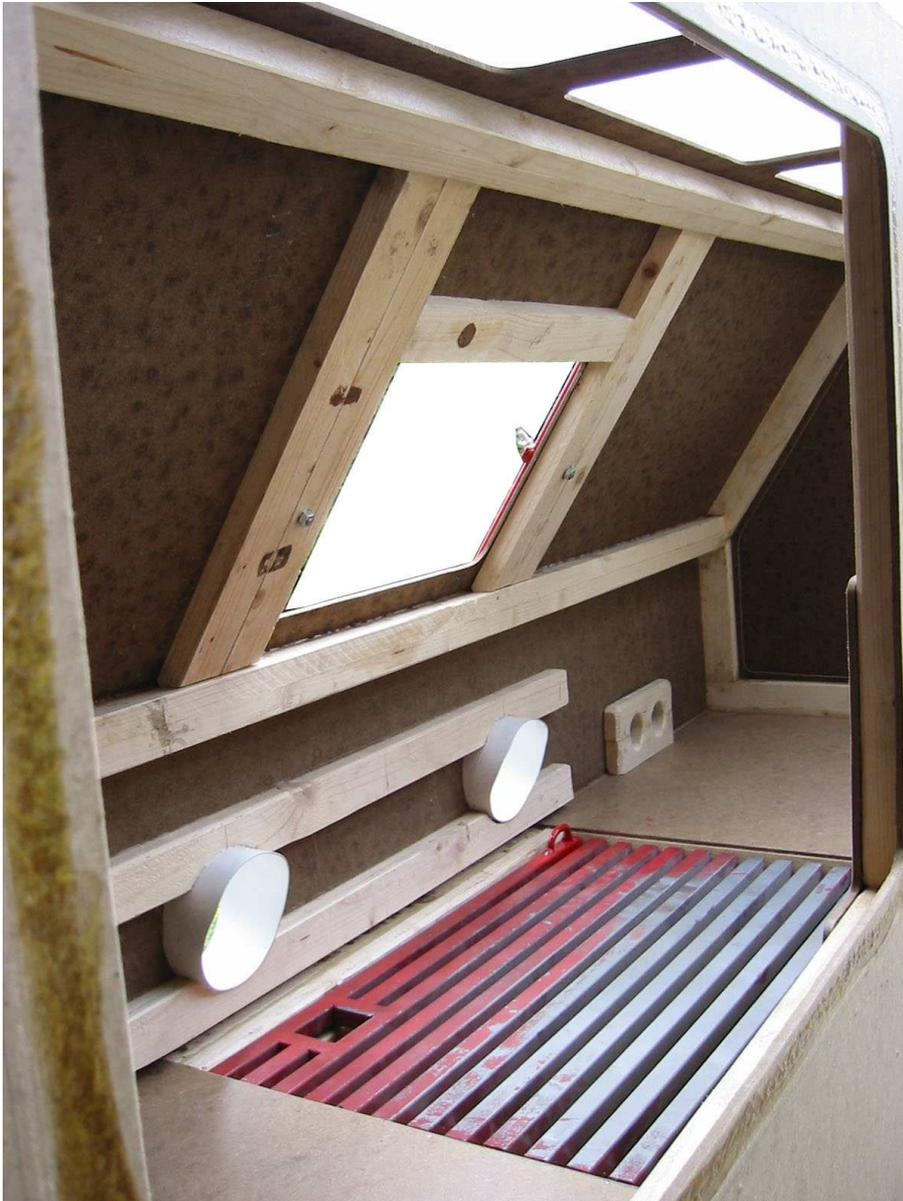
Hier sieht man die zusätzlich angebrachten Verstärkungen rund um die Durchsichtöffnung. Solche Verstärkungen sind nicht in meinen Plänen zu finden. Dazu einfach am fertigen Objekt die Länge ausmessen, Dachlatten zuschneiden und verleimen.
