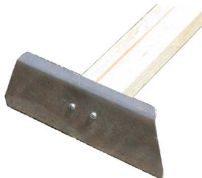
Den Sandrechen brauche ich um Sand aus der hintersten Ecke der Kabine in den Gitterrost zu schieben. Hergestellt ist er aus einer ca. 1,8 m langen Dachlatte, wo auf der einen Seite ein Blech von ca. 20 cm Breite angeschraubt wird.
