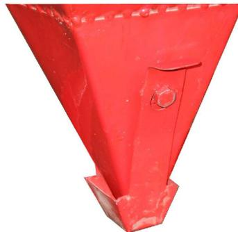
Die Trichteröffnung ist unten verschliessbar und bei Bedarf sollte sie leicht zu öffnen sein um das gesammelte Korund abzulassen. Der Trichter darf dabei nicht zu weit nach unten kommen, damit noch mindestens ein Kübel daruntergestellt werden kann.
