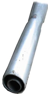
Das Rohr welches man in den Kübel mit Korund steckt besitzt noch ein zusätzliches Aussenrohr. Dadurch entsteht ein Luftkanal zwischen den zwei Rohren damit Luft nach unten gesaugt werden kann und zusammen mit dem angesaugten Korund nach oben gelangt.
