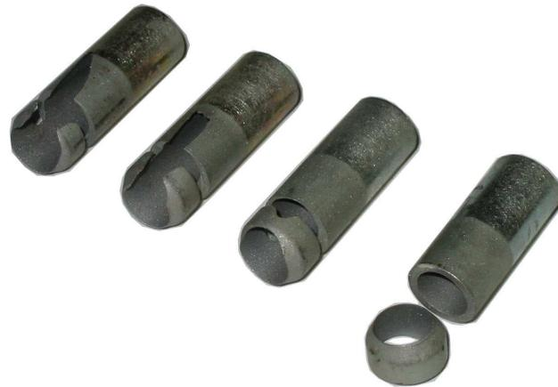
So sehen Stahldüsen nach je ca. 2 Std. Dauerbetrieb aus. Neben dem hohen Verschleiss hat man bei Stahldüsen zwei gravierende Nachteile. Erstens nimmt der Düsenquerschnitt mit der Zeit zu, wodurch man den Druck etwas erhöhen muss, um die selbe Leistung zu bekommen. Der zweite Nachteil besteht darin, dass man immer aufpassen muss, dass der Pistolenkörper nicht beschädigt wird, was mir bei den linken zwei Düsen beinahe passiert ist.
