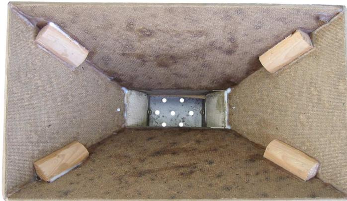
Im unteren Teil des Trichters befindet sich ein Blech mit 7 Löchern (5 mm Durchmesser). Diese sind für eine erste Verteilung des Sandes zuständig.
