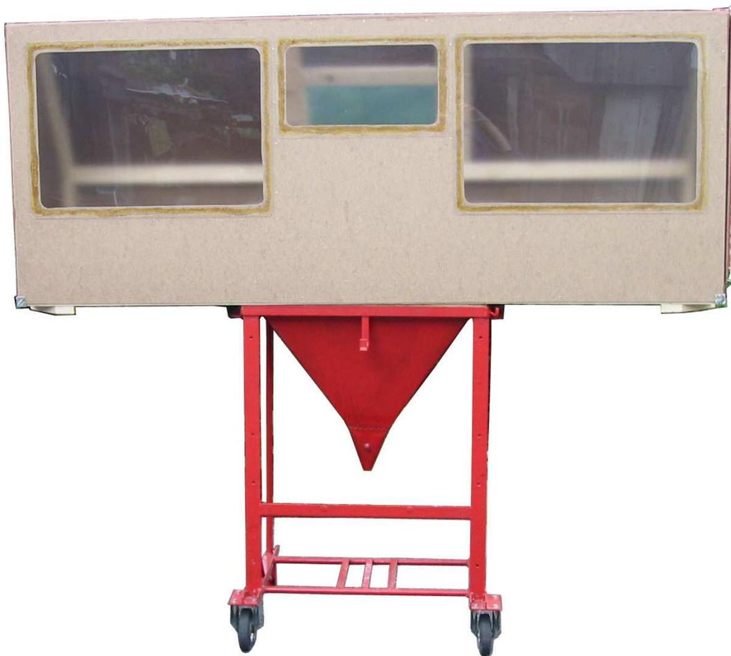
Auf der Rückseite sind es drei Plexiglasscheiben, die mit Kontaktkleber montiert werden. Wie bereits gesagt, empfehle ich zuerst einen Test mit dem Kontaktkleber zu machen, um festzustellen dass die Verbindung Plexigals mit Pavatex auch hält.
