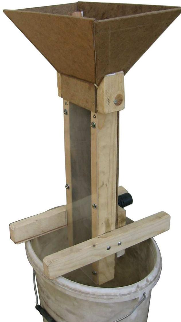
Um das Feintuning einfacher zu machen habe ich deshalb auf der einen Seite eine dememontierbare Plexiglasscheibe angebracht. Damit sieht man besser, wie gut der Sand verteilt wird und ob das Absaugen des Staubes korrekt funktioniert.
