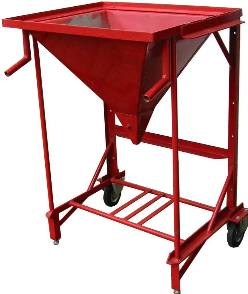
Das Fahrgestell hat zwei Räder und auf der Vorderseite steht das Gestell auf verstellbaren Schrauben, um bei unebenem Boden den Niveauunterschied auszugleichen. Auf der Vorderseite befinden sich auch zwei Griffe um das Ganze anzuheben und verschieben zu können.
