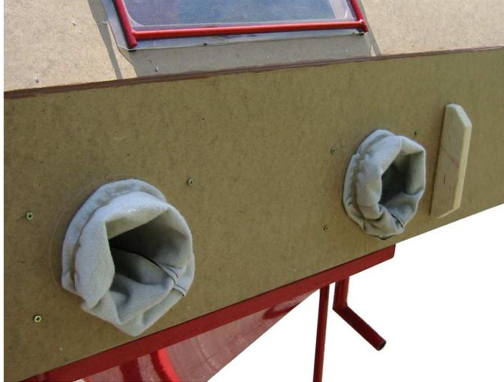
Zum Befestigen der Handschuhe werden diese einfach einmal umgeschlagen und dann mit Hilfe eines starken Gummis fixiert.
