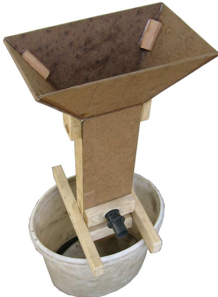
Den Flansch für den Staubsaugeranschluss (schwarzes Rohr) musste ich am Umfang lochen, da die Saugleistung des Staubsaugers zu gross war. Ich empfehle prinzipiell einmal genügend Löcher zu machen. Hat man zuviele Löcher angebracht, so legt man einfach ein Stofftuch über einen Teil der Löcher und die Saugleistung nimmt wieder zu.
