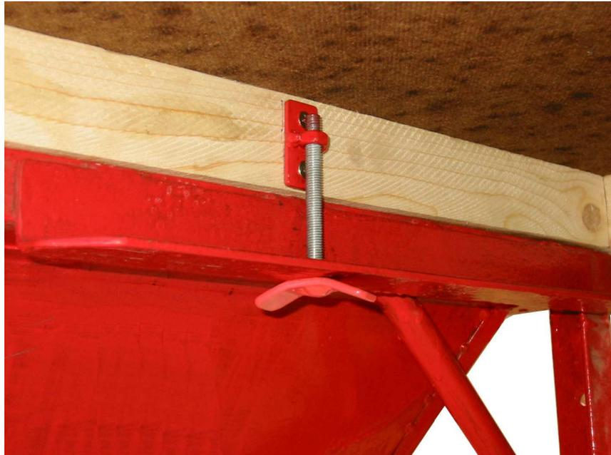
Damit das Fahrgestell und die Kabine gut miteinander verbunden sind, ist auf der linken und rechten Seite diese Sicherung angebracht. Sie ist geschraubt und kann leicht gelöst werden, falls man die beiden Teile einmal trennen will.
